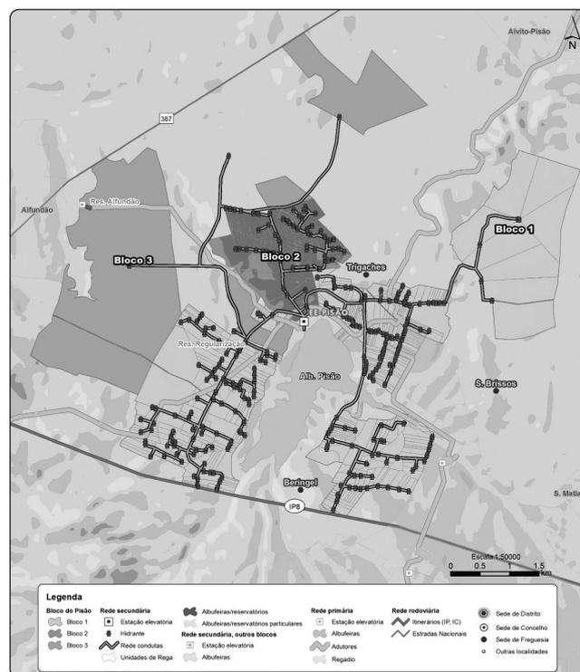
O Aproveitamento está dividido em três blocos, sendo 2 deles, o bloco 1 com uma área de 1363 ha e o bloco 2 com uma área de 271 ha, beneficiados diretamente através da estação elevatória do Pisão, situada a jusante da Barragem do Pisão, por dois patamares de elevação distintos.
