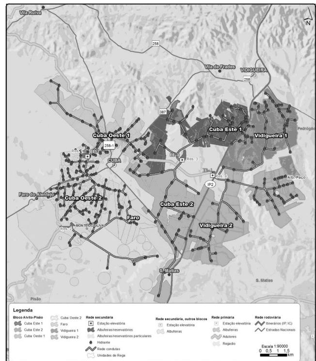
A jusante de cada um destes reservatórios (à exceção de Faro do Alentejo) encontra-se localizada uma estação elevatória, com dois patamares de elevação, que pressurizam duas redes independentes.
