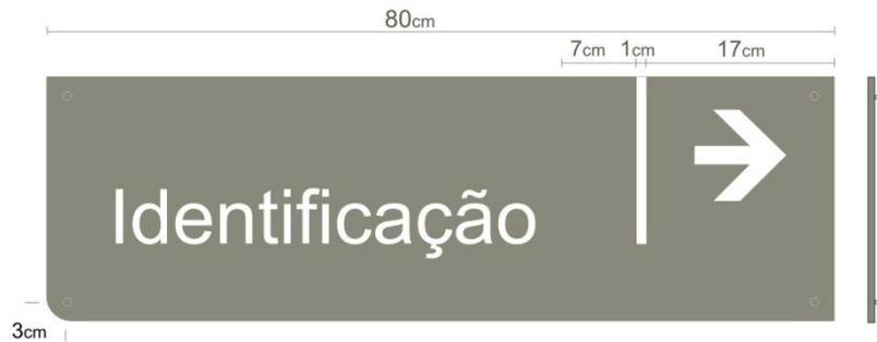
A estrutura poderá ser complementada com uma placa de proteção em acrílico com 4 mm e afixada em 4 pontos de apoio, de forma a ficar suspensa a uma distância de 8mm da placa metálica;
