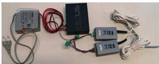
Fig. 2: Fonte de alimentação/Concentrador NIDUS C/ conversores / sensores
