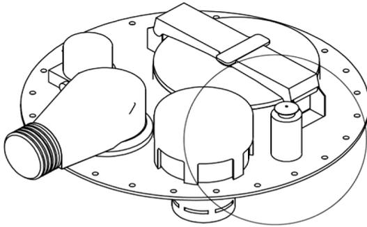
Figura 1: Selagem do compartimento da cisterna.
