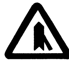
A12 a — Entroncamento com via sem prioridade
