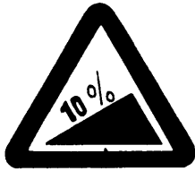
A9 — Subida de inclinação acentuada
