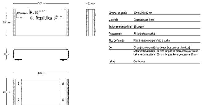
Modelo 2 — placa toponímica de fixação perpendicular à parede
