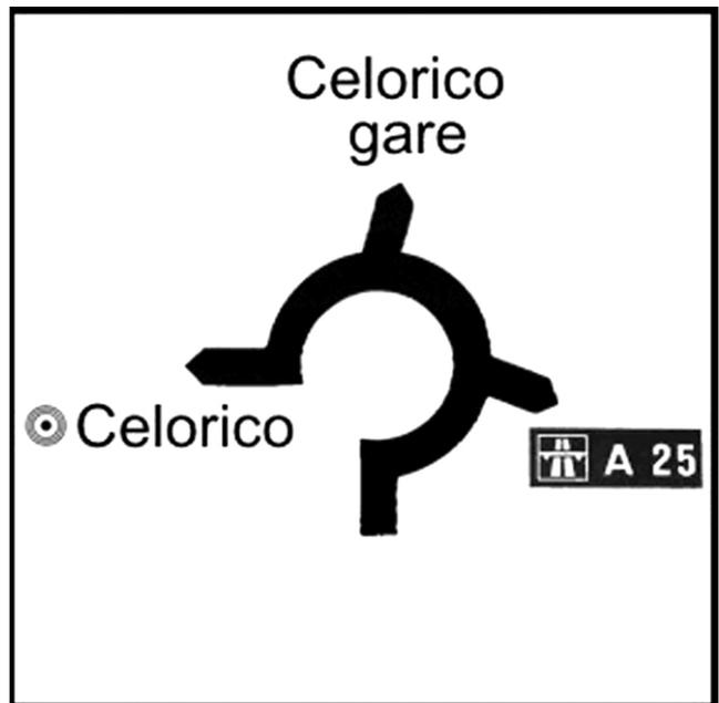
(I2c) — Pré-aviso gráfico (intersecção de nível), em direcção à rotunda da Central de Transportes, tal como no esquema seguinte:
