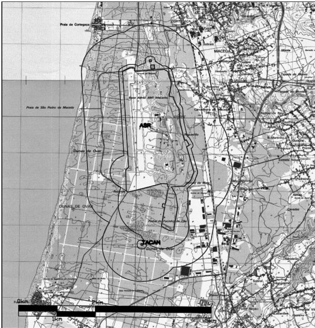
Planta das zonas de proteção radioelétrica
