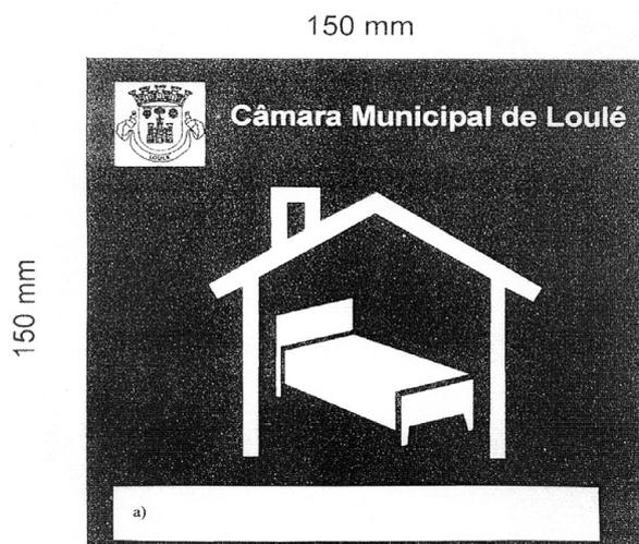
As placas em acrílico branco opaco de 3 mm de espessura e com a dimensão de 150 mm × 150 mm.
