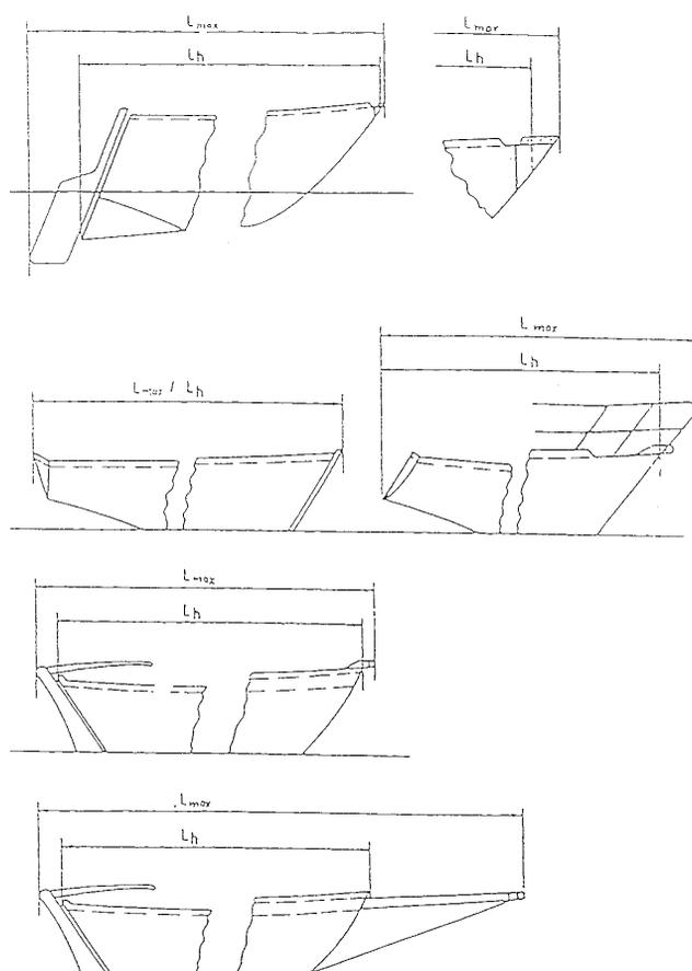
Figura 1.2 — Determinação do  $L_h$  e do  $L_{max}$  em monocascos
