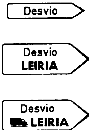
DT8 (Exemplos de sinais de direcção de desvio ou de itinerário recomendado)
