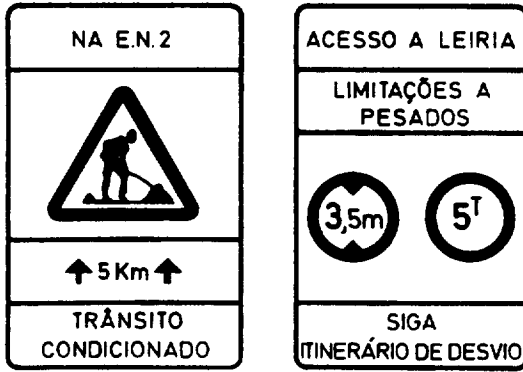
DT12 (Exemplos de sinais de realização de obras importantes na via)
