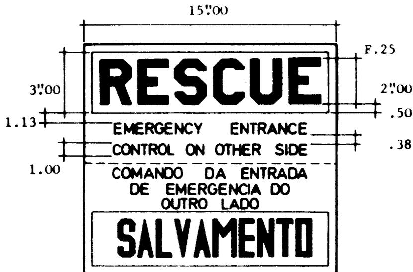
Pintar este «placard» no lado do do avião oposto ao local do comando da entrada de emergência, à mesma altura e na altura e na mesma estação.
