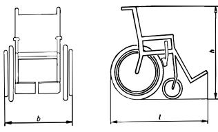
Comprimento total (l) — 1200 mm. Largura máxima (b) — 700 mm. Altura total (h) — 1090 mm.
