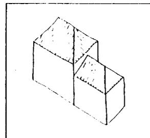
Em terrenos de elevada inclinação, a solução adequada para a cobertura poderá exigir menor número de águas.
